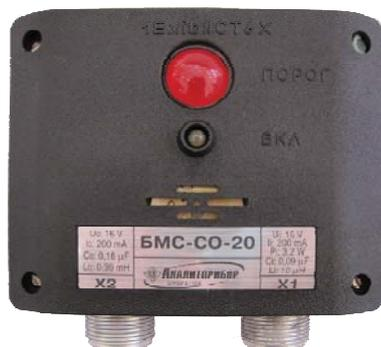
Предназначен для работы совместно с датчиками-газоанализаторами ДАТ-М-01...-04, ДАХ-М-01...-04 и обеспечивают выдачу световой и звуковой сигнализации при достижении выходным токовым сигналом с датчика фиксированного порога срабатывания.
